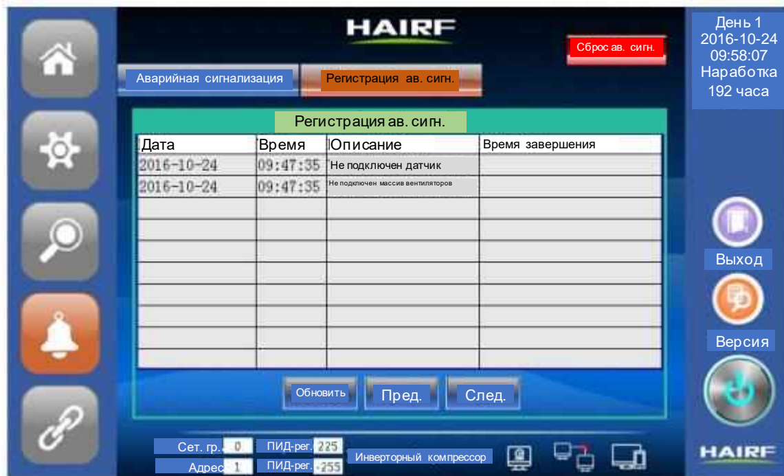
Рисунок 3-21. Интерфейс запроса журнала аварийных сигналов
