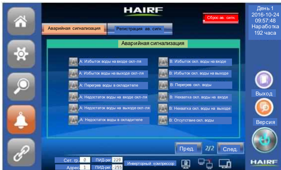
Рисунок 3-20. Интерфейс запроса текущего аварийного сигнала
