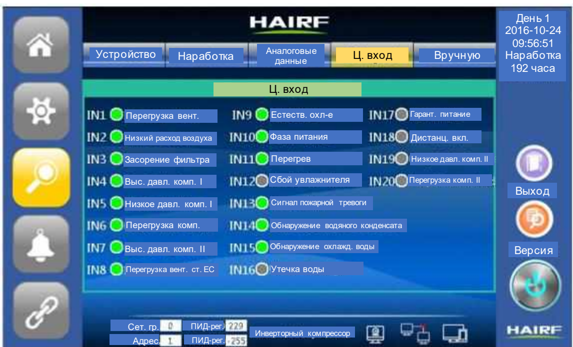
Рисунок 3-17. Интерфейс запроса состояния входного порта
