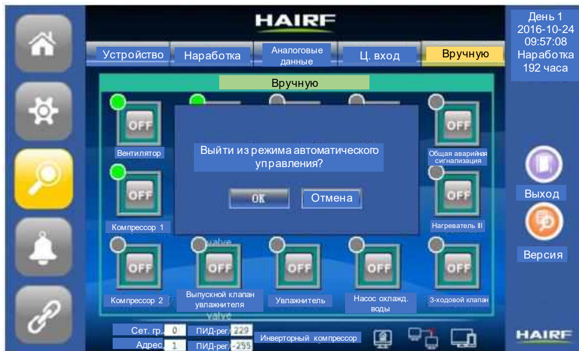
Рисунок 3-18. Интерфейс ручного управления
