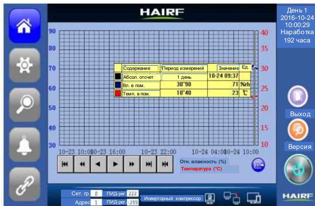
Рисунок 3-2. Интерфейс кривых изменения температуры и влажности
