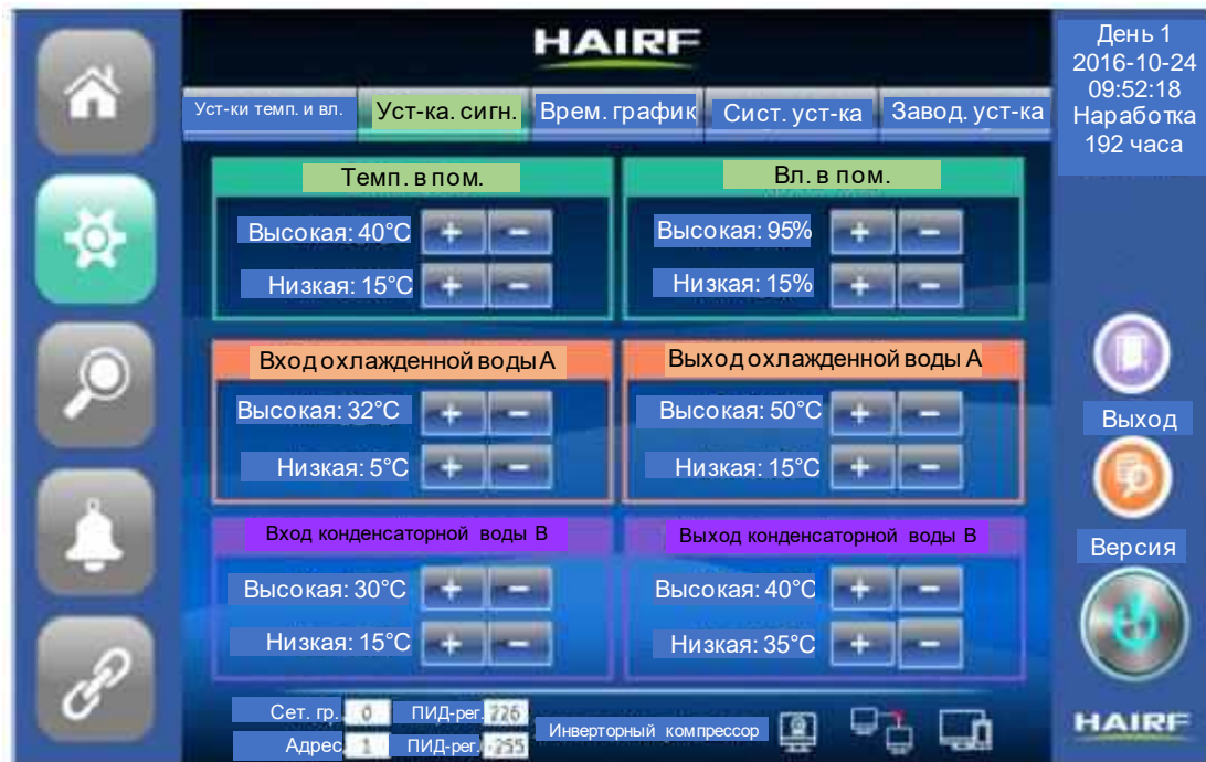
Рисунок 3-4. Интерфейс настройки параметров аварийной сигнализации
