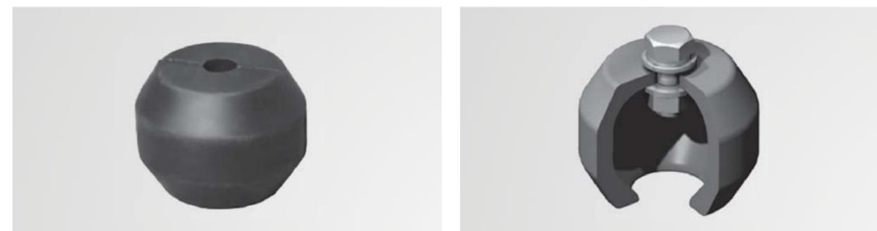
Виброизоляторы резиновые сложной формы типа ВР предназначены для работы в качестве основных упругих связей между колеблющимися и неподвижными частями машин, а также для виброизоляции машин. Данный тип виброизоляторов представляет собой резиновый бочонок, выполненный с использованием резиновых виброгасителей и предназначенный для уменьшения динамических усилий, которые передаются от установленного агрегата.
