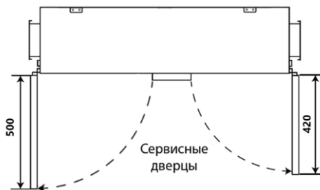
Рис. 6. Сервисное пространство снизу
