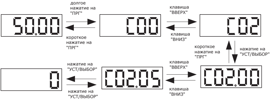
Рисунок 5.5-3. Основные операции на панели управления
