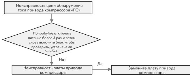
Если на газоразрядной трубке отображается «РС», это означает, что имеется неисправность цепи обнаружения тока привода компрессора.
