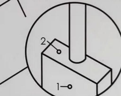
В такере предназначено гнездо для фиксации и хранения шестигранного ключа
