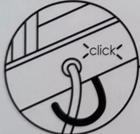
Внимание! Рукоятка Такера находится в сжатом состоянии. Перед использованием инструмента необходимо достать чеку из отверстия №1 и вставить чеку в отверстие №2. Для транспортировки инструмента необходимо совершить действия в обратном порядке.
