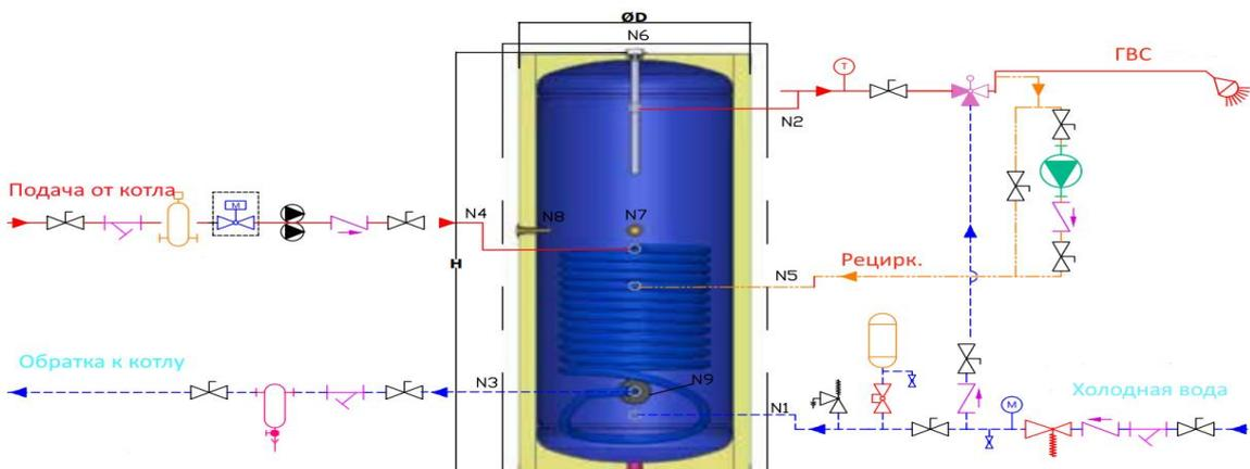
Обязательно использовать автоматический предохранительный клапан Макс. 8 бар.
