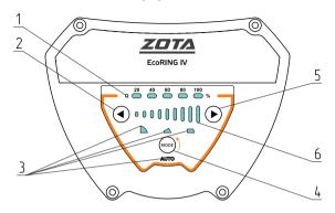
Рис.16 Элементы панели управления
