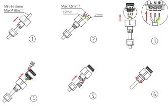
Рис.9 Схема электроподключения
