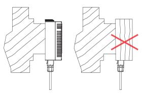
Рис.8 Правильная термоизоляция корпуса насоса
