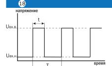
Т - период сигнала t - время импульса d=t/Tx100% - коэффициент заполнения
