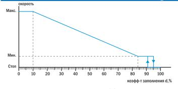
Рис.14 Зависимость скорости от коэффциента заполнения
