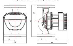
Рис.2 Обозначение монтажных размеров насов с фланцевым соединением
