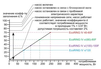
Рис.15 Зависимость коэффициента заполнения от состояния насоса
