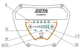
Рис.17 Световые области на панели управления
