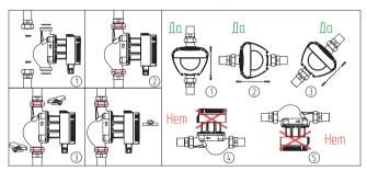
Рис.5 Установка насоса
