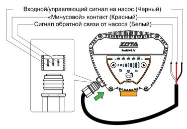
Рис.11 Схема подключения ШИМ-сигнала.
