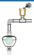
Рис. 22 Удаление воздуха из системы отопления
