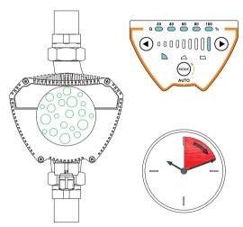
Рис.21 Удаление воздуха из насоса
