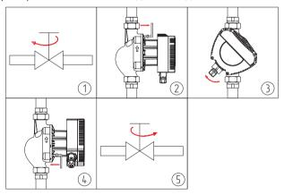
Рис.7 Изменение положения клеммной коробки
