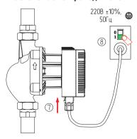
Рис.10 Электроподключение насоса
