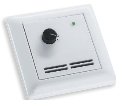
FSTF xx LD2 Исполнение с датчиком, светодиодом (зеленым) и поворотным переключателем (двухпозиционным) (макс. 24 В перем./пост. тока, макс. 130 мА)
