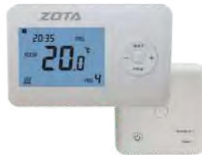
Комнатный хронотермостат предназначен для автоматического регулирования и поддержания заданной температуры воздуха в помещении путём подачи управляющего сигнала на элементы климатических систем (котел, насос, вентилятор, сервопривод и т.д.). Он дает возможность недельного программирования температурных режимов с разбивкой каждого суток на 4 временных интервала.
