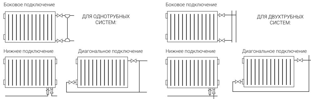
**Во избежание снижения номинальной тепловой мощности радиаторов длиной свыше 140 см рекомендуется подключение по диагональной схеме.**
