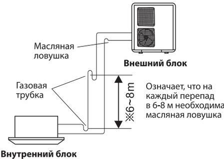
Эта схема предназначена для пояснения. Фактическая установка будет отличаться от этой в зависимости от условий на месте. При изготовлении масляной ловушки радиус изгиба должен быть в 1,5-2 раза больше диаметра трубы.
