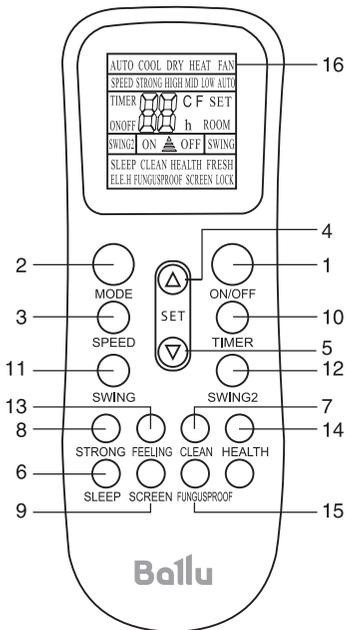
1. Кнопка ON/OFF – включение/выключение
