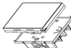
1. Разберите главный щит управления: протяните плоскую отвертку шириной 3,5 мм вдоль скоса на глубину 4 мм в гнездо для карты и с небольшим усилием подденьте вверх, чтобы открыть захватный крючок.
