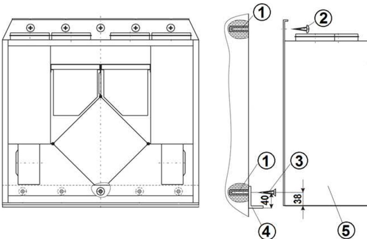
1 – Штифт; 2 – Шуруп с полукруглой головкой; 3 – Шуруп с потайной головкой; 4 – Подвес; 5 – Установка.
