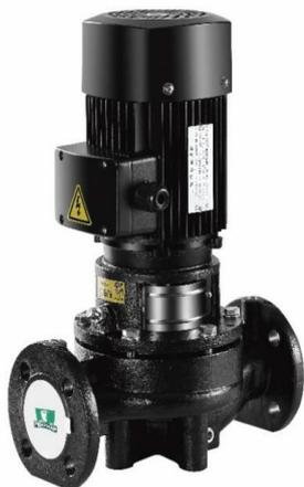
**Серия TD** – это одноступенчатые, моноблочные, центробежные насосы типа «ин-лайн» с торцевым уплотнением вала. При проектировании мы используем просчитанную гидравлическую модель. Проточная часть насоса изготавливается по технологии точного литья. Эта технология обеспечивает гладкость проточной части, малое трение и высокую эффективность.
