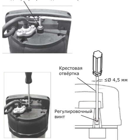
Рис. 3 Регулировочный винт колодезной насосной установки AQUATRON
