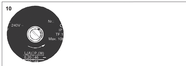
Рис. 10 – ПРОВЕРКА ВРАЩЕНИЯ РОТОРА НАСОСА (во время первоначального пуска и длительного перерыва в работе насоса, в начале отопительного сезона)
