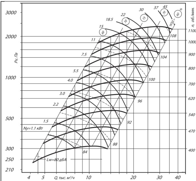
**Аэродинамическая характеристика RAD-RHP №6,3 схема 5**
