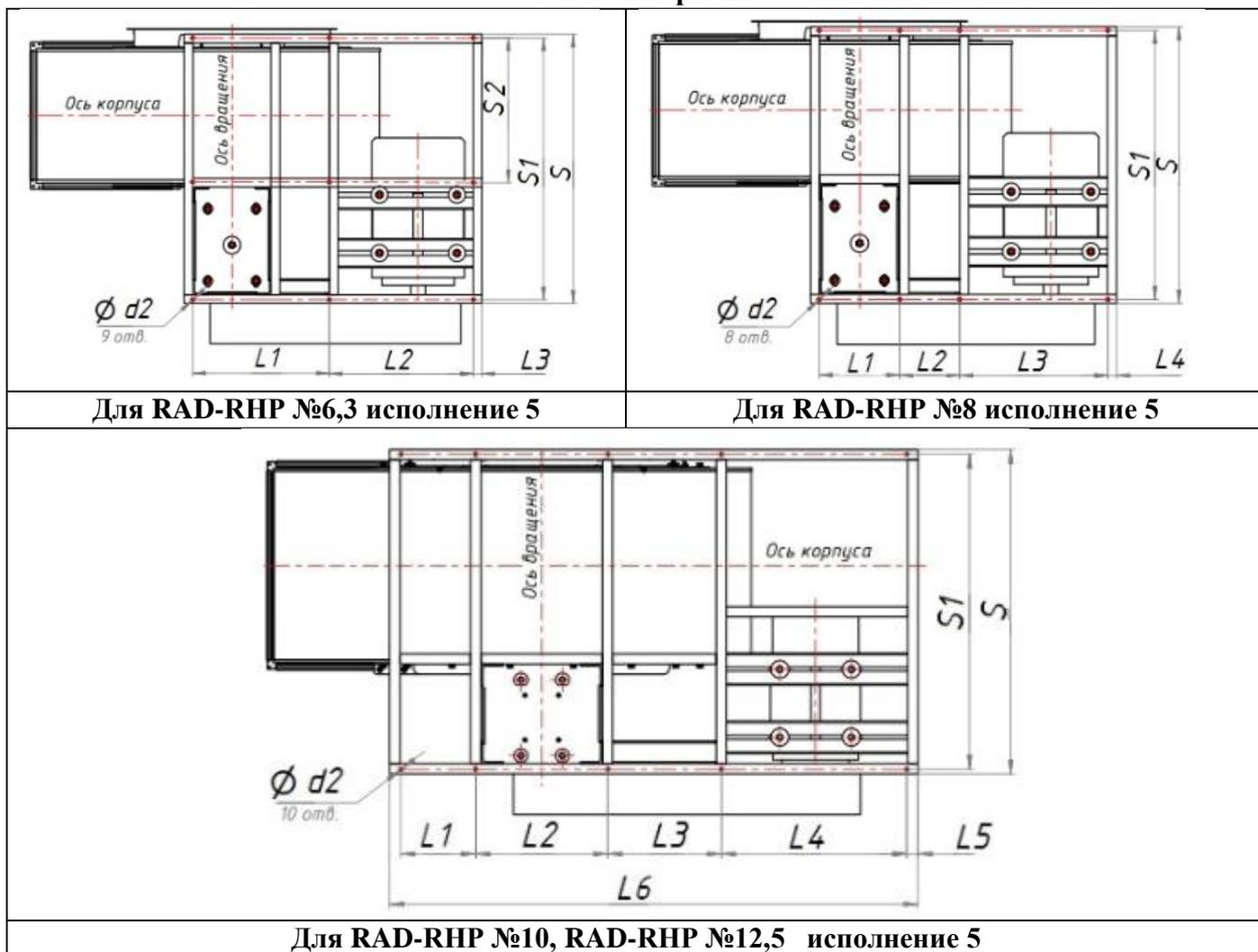
Рисунок 4-Габаритные размеры вентилятора
