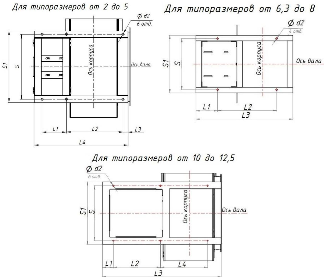
РИС. 2. Основание рамы вентиляторов RAD-RHP
