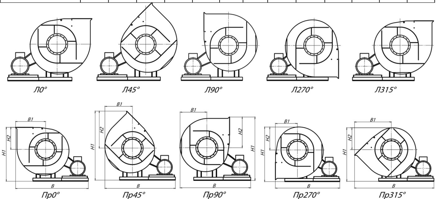
Рисунок 5- габаритные размеры зависящие от положения корпуса
