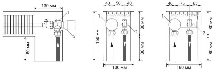
Ширина конвектора 130 мм, высота 130 и 180 мм
