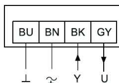
Привод с 3-позиционным управлением
