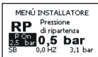
17.ábra: Az újraindítási nyomás beállítása
