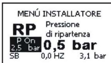
Figure 17: Configuration de la pression de redémarrage
