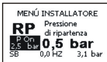
Afbeelding 17: instelling van de druk voor herstart
