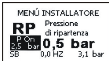
Σχήμα 17: Ρύθμιση της πίεσης επανεκκίνησης
