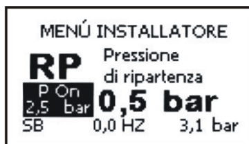
Figura 17: Configuración de la presión por re arranque
