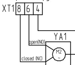
Подключение привода с возвратной пружиной или клапана
