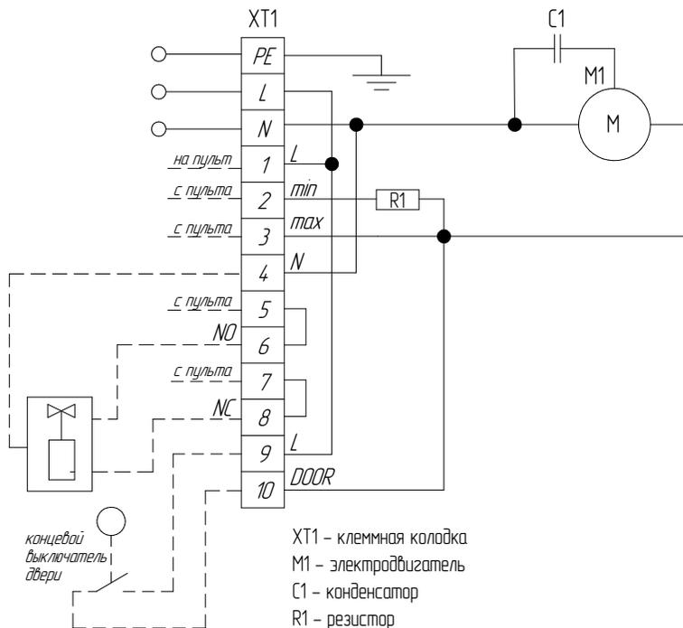
**Схема электрическая принципиальная группового подключения тепловой завесы ВНС-Н15W30-SP**
