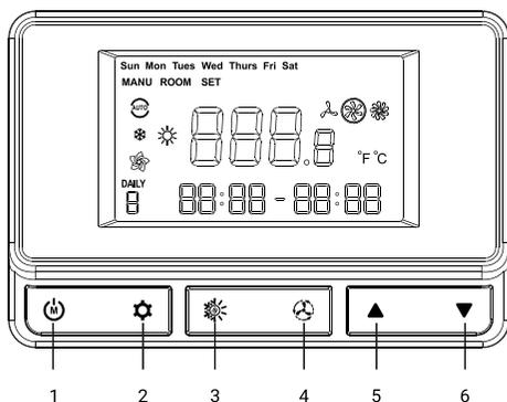
1. Включение питания и переключения между ручным и автоматическим режимом.
