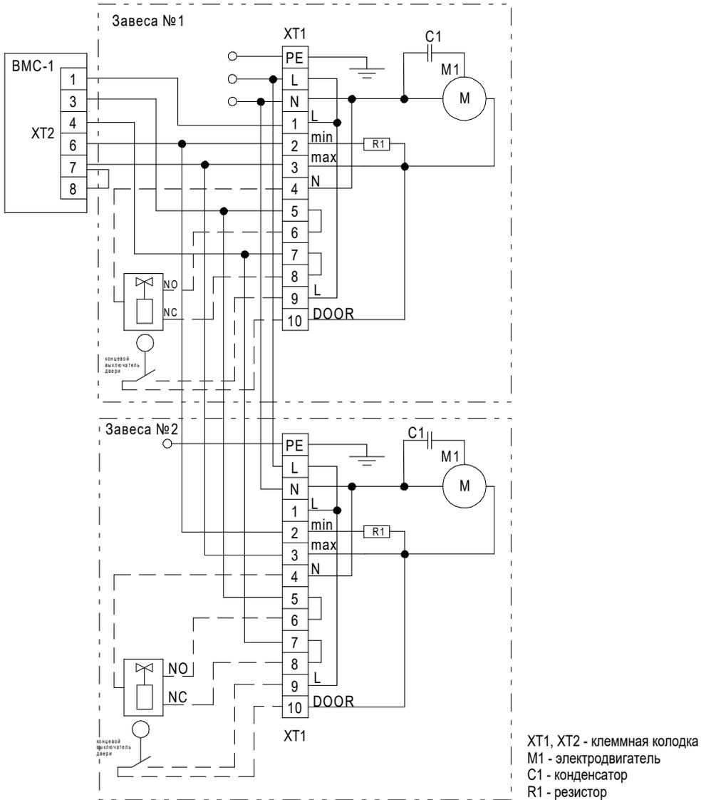
**Схема электрическая принципиальная подключения тепловой завесы ВНС-Н15W30-SP к пульту ВМС-2**
