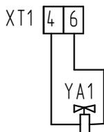
Пример подключения привода с возвратной пружиной/клапана и насоса.
