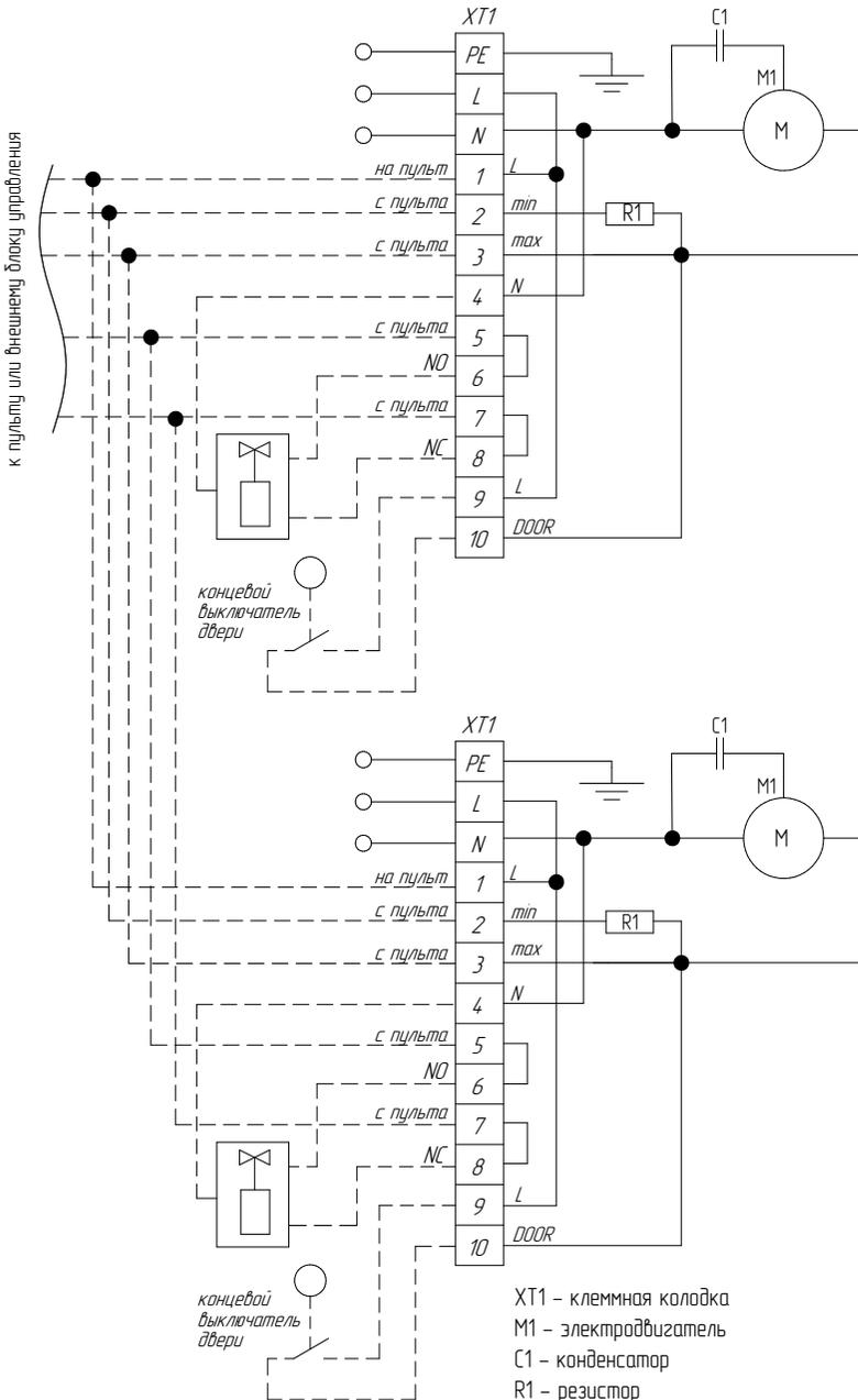
**Схема электрическая принципиальная подключения тепловой завесы ВНС-Н15W30-SP к пульту ВМС-1**
