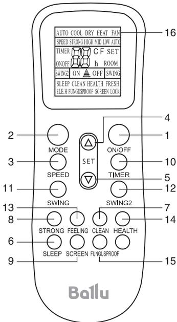
1. Кнопка ON/OFF – включение/выключение
