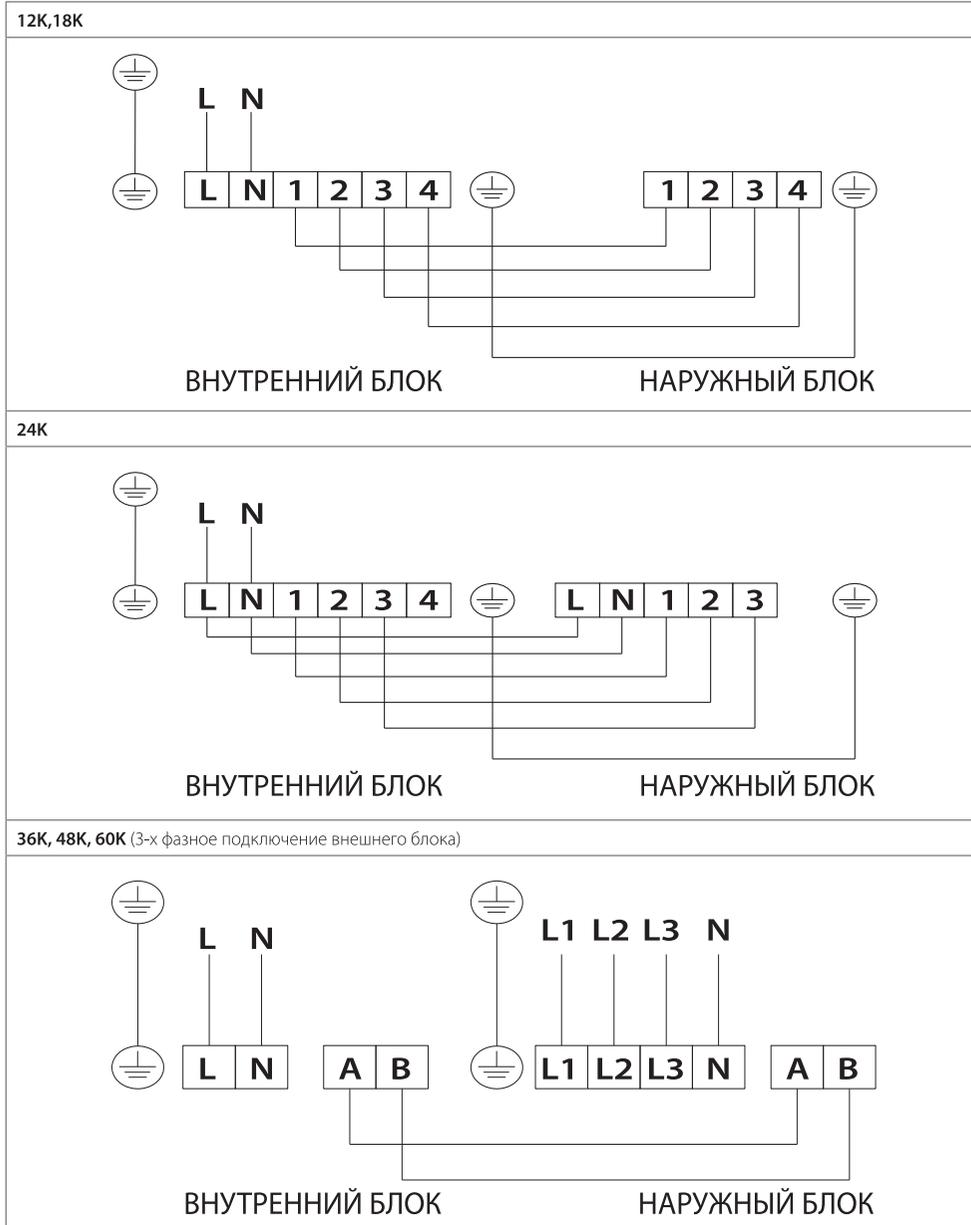
4.2. СХЕМЫ ЭЛЕКТРИЧЕСКИХ СОЕДИНЕНИЙ ВНУТРЕННИХ БЛОКОВ:
