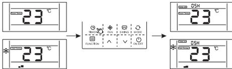
После входа в интерфейс установки времени время по умолчанию составляет 0,5 часов, в этот момент нажмите кнопку «Λ» или «V», чтобы отрегулировать время. Если кнопка не будет нажата в течение 10 секунд, настройка синхронизации будет отменена, а затем вернется в состояние отсутствия синхронизации.
