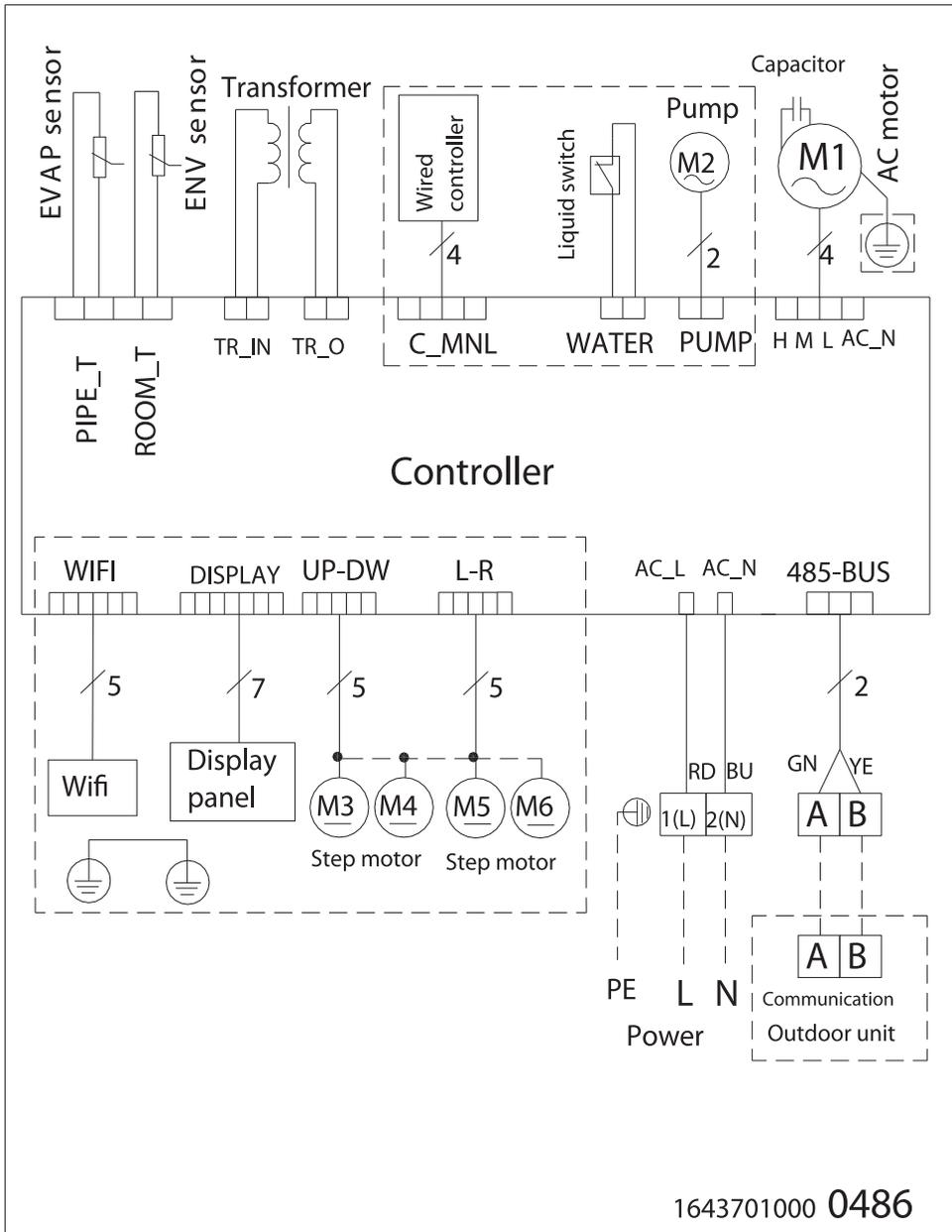
4.3. СХЕМЫ ЭЛЕКТРИЧЕСКИХ СОЕДИНЕНИЙ ВНЕШНИХ БЛОКОВ:
