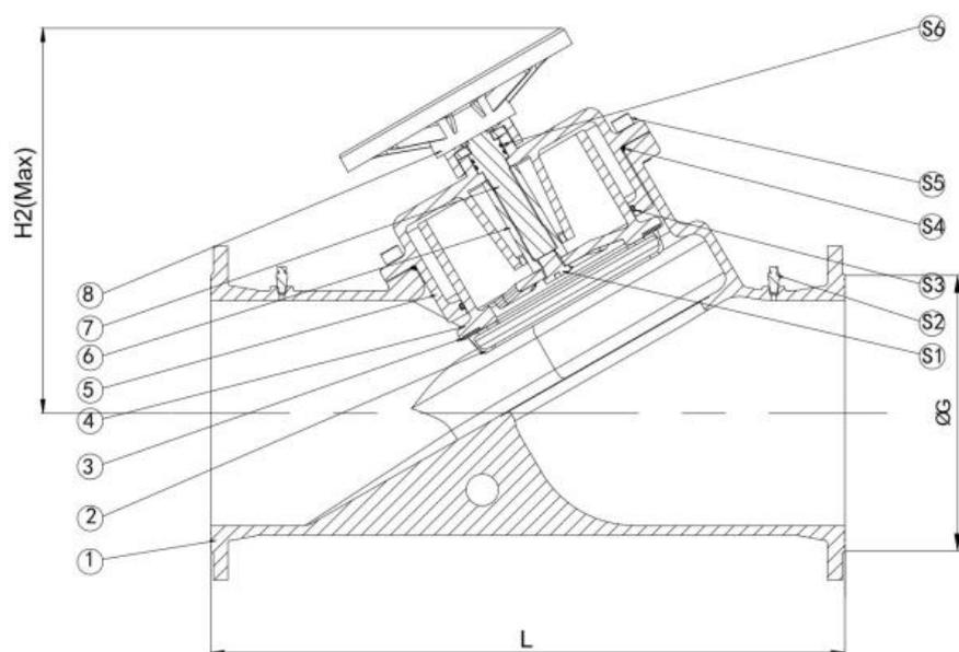
1. Корпус; 2. Конус; 3. Уплотнение; 4. Втулка; 5. Крышка; 6. Направляющая штока; 7. Шток 8. Рукоятка; S1 Болт; S2, S5 Болт Измерительный ниппель; S3, S4, S6 Кольцевые уплотнения;
