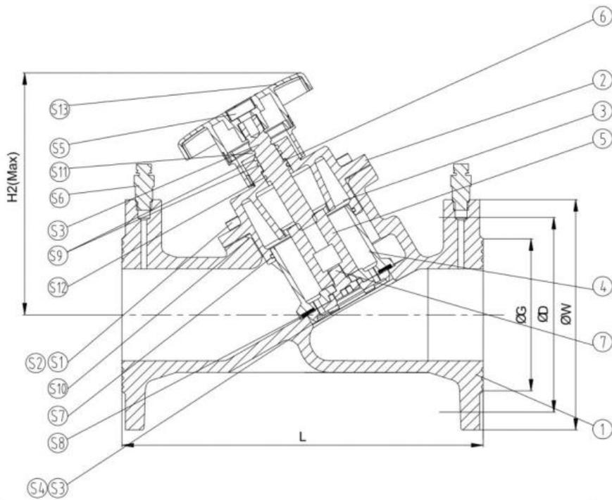
1. Корпус; 2. Крышка корпуса; 3. Втулка; 4. Конус; 5. Направляющая штока; 6. Шток; 7, S1, S3, S5 Болт; S2, S4 Уплотнение; S6 Измерительный ниппель; S7, S9, S10, S12 Кольцевые уплотнения; S8 Уплотнение конуса S11 Стопорное кольцо; S13 Рукоятка.
