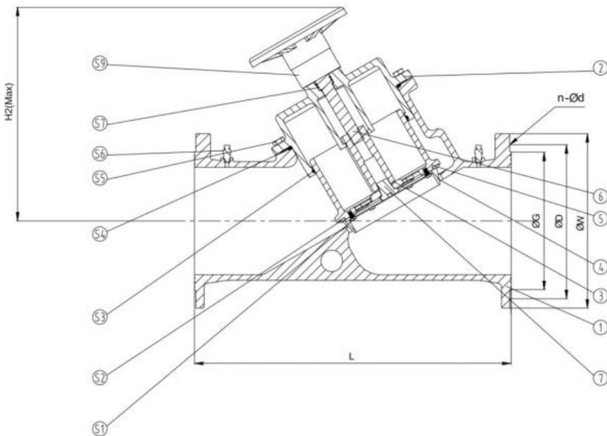
1. Корпус; 2. Крышка корпуса; 3. Втулка; 4. Конус; 5. Направляющая штока; 6. Шток; 7. Винт; S1 Болт; S2 Уплотнение; S3, S4, S7 Кольцевые уплотнения; S5 Болт; S6 Измерительный ниппель; S8 Рукоятка.
