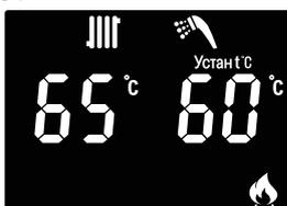
Котел будет запускаться только в том случае, если устанавливаемая температура выше фактической температуры теплоносителя в системе отопления, отображаемой на дисплее.
