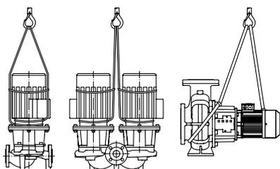
Рис. 7. Транспортировка насоса
