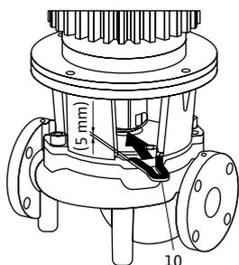
Рис. 18. Монтажная вилка для работ по настройке
