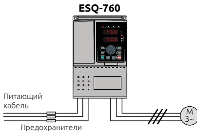
Рисунок 3-23. Схема установки предохранителей.
