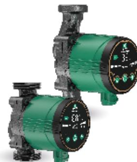
Циркуляционные насосы серии NEWSTAR на постоянных магнитах с частотным управлением и автоматическим режимом работы. Может работать с постоянной скоростью, перепадом по давлению, поддерживать постоянное давление или автоматически настроиться под систему. Рабочая камера защищена от коррозии катафорезным покрытием. Предназначены для быстрой циркуляции в системах отопления, кондиционирования и теплого пола.
