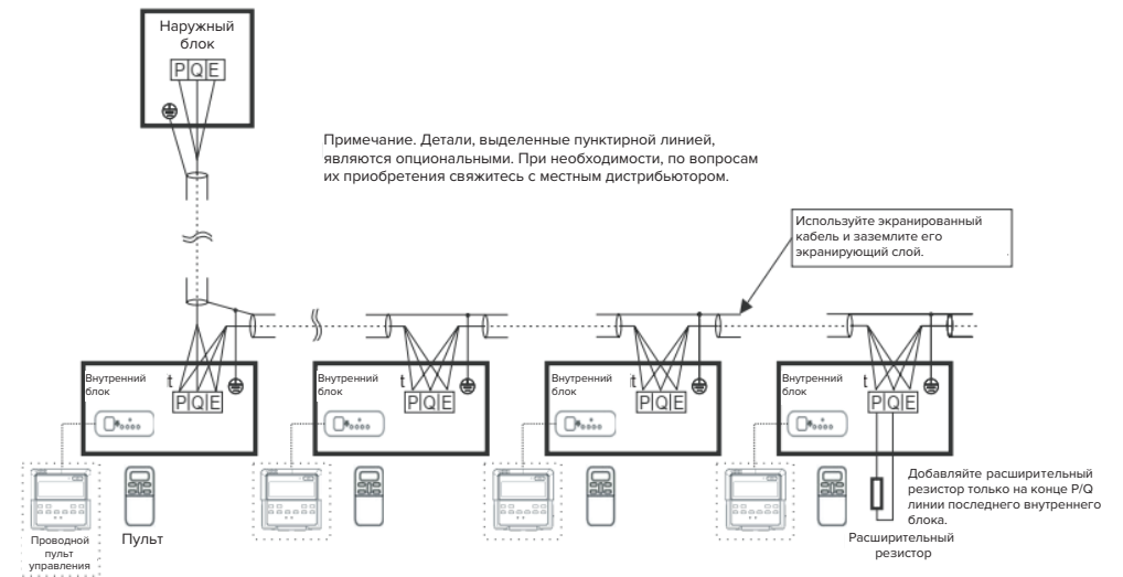
Рис. 5-2 Подключение внутреннего блока и управление наружным блоком
