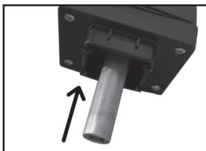
3. Затяните винт на приводе для закрепления вала.
