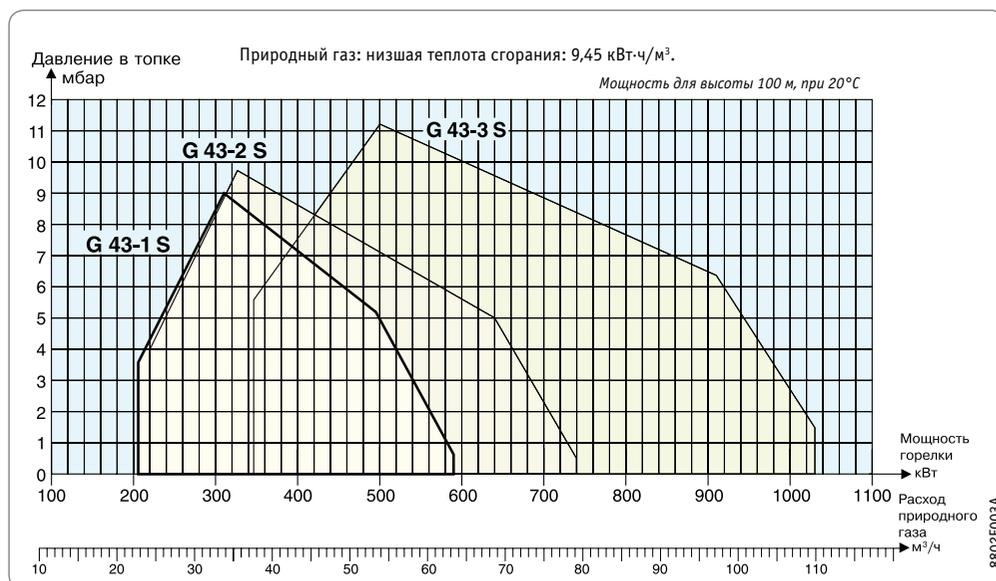
Настройку горелки должен осуществлять специалист при соблюдении условий по установке. Мощность горелки должна соответствовать мощности котла, на который она устанавливается, с учетом КПД.
