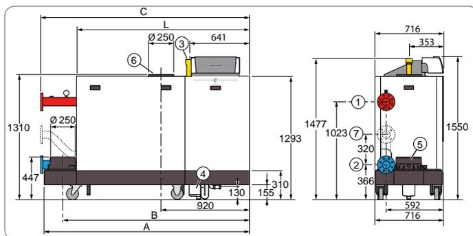
C 340 – панель управления слева, гидравлические подключения справа
