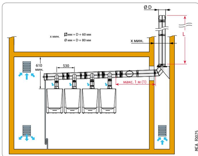
Использовать только дымоходы, предназначенные для такого типа оборудования. В частности, возможно использование пластиковых дымоходов ВАХІ для каскадных систем. Для получения дополнительной информации обратиться к нам.
