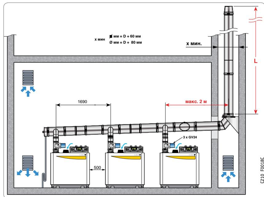
Макс. в зависимости от диаметра трубопровода D (мм) для различных комбинаций каскадной установки С 230 (Значения длин были определены с учетом размеров, приведенных выше. Для других случаев требуется расчет.)
