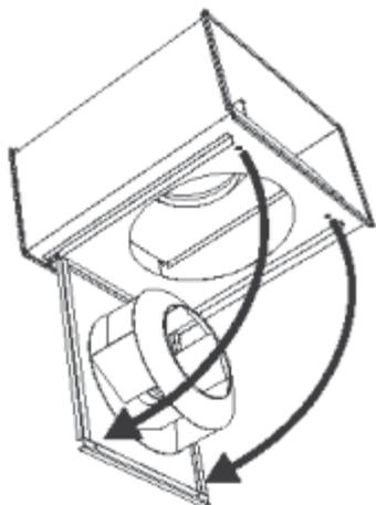
При установке необходимо оставить достаточно места для открытия крышки обслуживания крыльчатки вентилятора.
