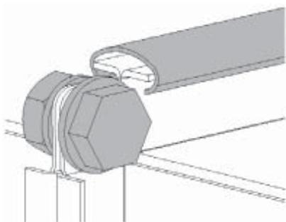
К воздуховодам вентилятор монтируется болтами и С-профилем.
