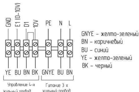
Схема подключения Tornado (380/50/3ф.)
