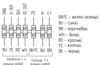
Схема подключения Tornado (230/50/1ф.)
