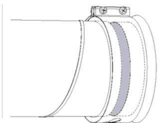
При использовании переходников рекомендуется использовать гибкие соединения круглого воздуховода.
