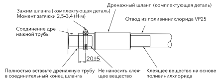
Полностью вставьте дренажную трубу в соединительный конец шланга
