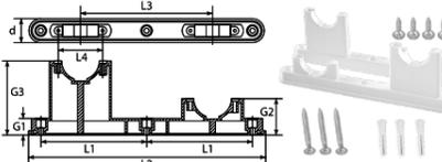
Предназначен для крепления PP-R коллекторов на плоской поверхности.
