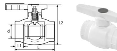
Шаровой запорный кран. Предназначен под сварку. Работает в двух положениях — открыт и закрыт. Уплотнение штока EPDM. Рабочая температура до +85°C.
