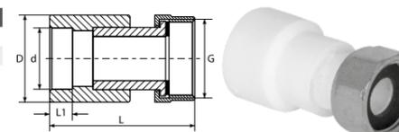
Разъемное соединение между полипропиленовой трубой и металлической трубой или фитингом с наружной трубной резьбой (пластиковый штуцер).
