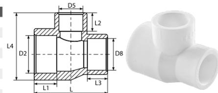
Тройник под сварку для соединения труб и фитингов разных диаметров.
