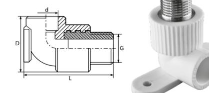
**УГОЛЬНИК С НАКИДНОЙ ГАЙКОЙ (МЕТАЛ. ШТУЦЕР)**
