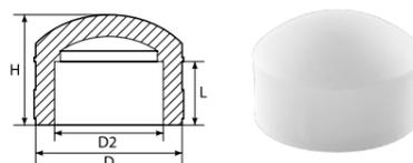
Предназначена для заглушки конца трубы при помощи сварки.
