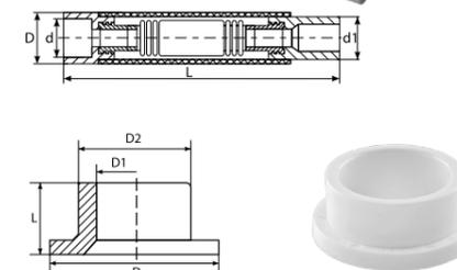
Для создания фланцевого соединения – при переходе на другую трубу или задвижку. Для соединения требуется специальный стальной расточной фланец. Труба вваривается внутрь бурта.
