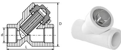
Предназначен для фильтрации, потока жидкости и газа. Фильтрующий элемент – сетка из нержавеющей стали. Рекомендуем для систем ГВС и ХВС.
