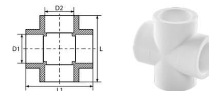
Для соединения четырех труб одного диаметра в одной плоскости.
