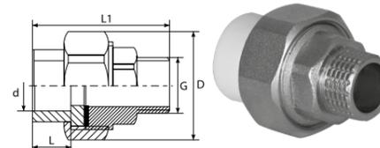
Используется для получения разъемного соединения между металлической и полипропиленовой трубами. На резьбовом штуцере имеется шестигранник, за который муфта удерживается при затяжке.
