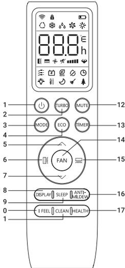
1. Кнопка ON/OFF – включение/выключение.
