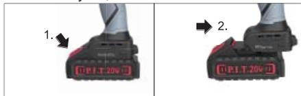
Чтобы извлечь аккумуляторную батарею, нажмите на кнопку разблокировки и извлеките аккумулятор из электроинструмента. **Не применяйте при этом силы.**
