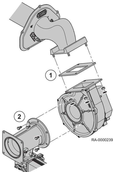
1. Отвернуть гайки с шайбами и отсоединить вентилятор с уплотнением от крышки горелки
