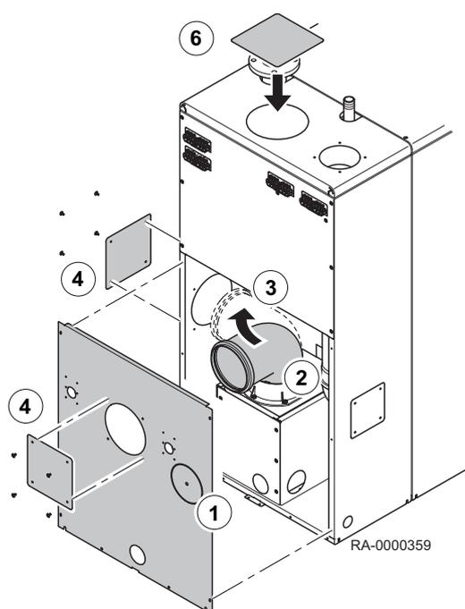
1. Снять заднюю нижнюю стенку
