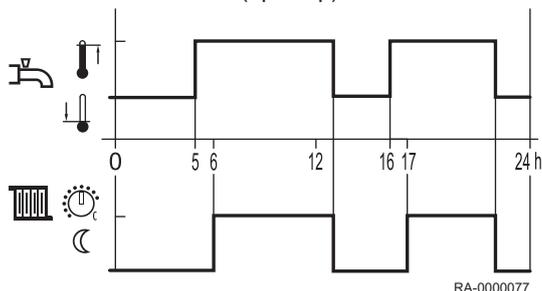
Рис.31 Разблокировка в соответствии с суточной программой 4 (пример)
