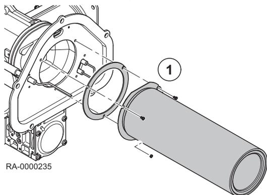
Рис.44 Снятие крышки коллектора дымовых газов
