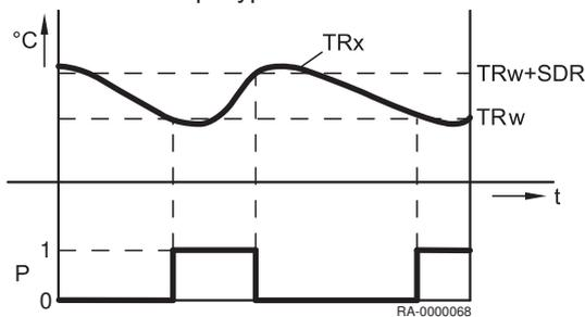
Рис.26 Ускоренный нагрев
