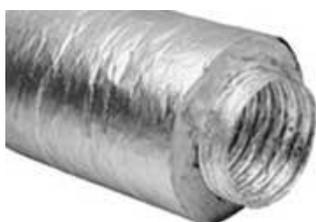
**ISOBFA - Гибкие теплоизолированные** воздуховоды предназначены для вентиляции и кондиционирования воздуха. Теплоизолированный воздуховод изготавливается из многослойной металлизированной полимерной пленки со спиральным каркасом из стальной проволоки между слоями, слоя теплоизоляции толщиной 25 мм и наружного чехла, выполненного из металлизированной пленки. Легко соединяется с каналами круглого и овального сечения. При высоких температурах или в случае пожара токсичные газы не выделяются.
