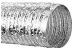
**BFA - Гибкие неизолированные** воздуховоды изготавливаются из многослойной металлизированной полимерной пленки со спиральным каркасом из стальной проволоки между слоями. Воздуховоды используются в системах кондиционирования и вентиляции с малым и средним давлением. Легко соединяются с каналами круглого и овального сечения. При высоких температурах или в случае пожара токсичные газы не выделяются.
