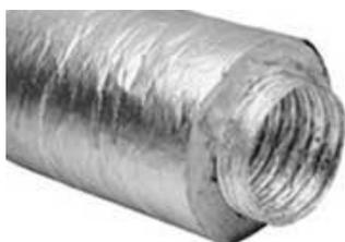
**SONOBFA-H - Звуко- теплоизолированные гибкие воздуховоды** изготавливается многослойной пленки с алюминиевой фольгой со спиральным каркасом из стальной проволоки между слоями с микроперфорацией внутреннего воздуховода и теплоизоляцией толщиной 25 мм, и паро- изоляцией из ставроленового рукава. Звукопоглощающие воздуховоды снабжены защитной оболочкой для избегания попадания частиц изоляции в воздушный поток. Внешний чехол изготовлен из металлизированной пленки.
