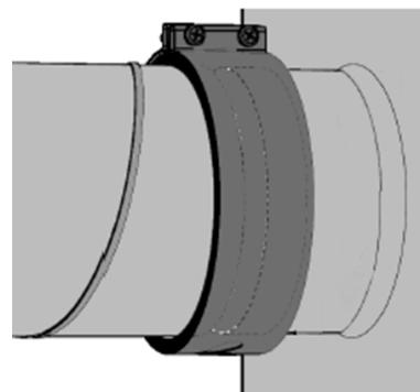
Датчик температуры приточного воздуха монтировать в воздуховоде как можно дальше от установки, но до первого поворота или отвода.
