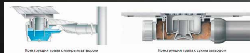
Конструкция трапа с мокрым затвором
