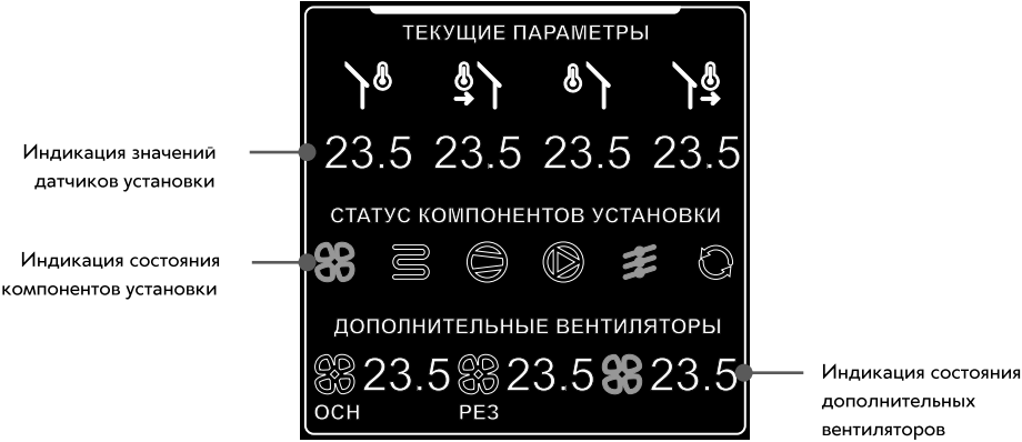
Рис. 17. Информация о состоянии компонентов установки
