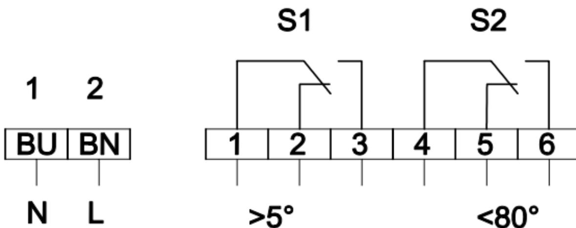
Рис. 8. Пример электрической схемы подключения клапана SH с электромеханическим приводом с возвратной пружиной В (Gruner)
