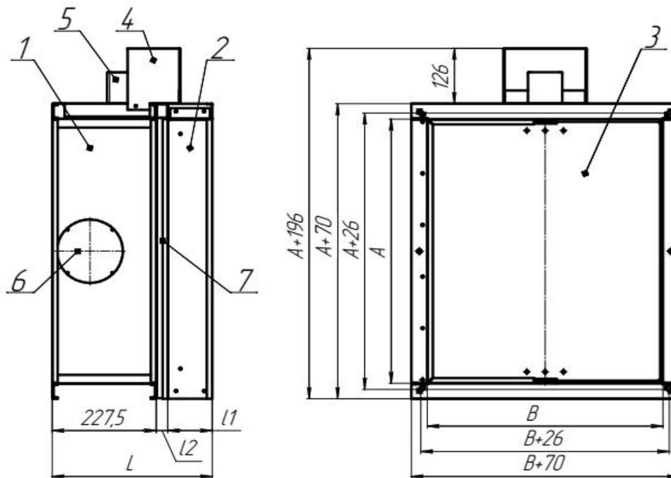
Рис. 3 Прямоугольный клапан с пределом огнестойкости EI 90-180.
