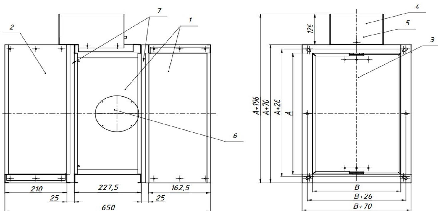
Рис. 6 Прямоугольный клапан двойного действия SHFD2W.
