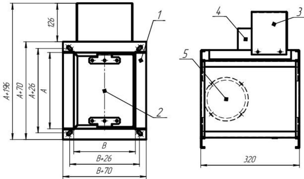
Рис. 1 Прямоугольный клапан с пределом огнестойкости EI 60.
