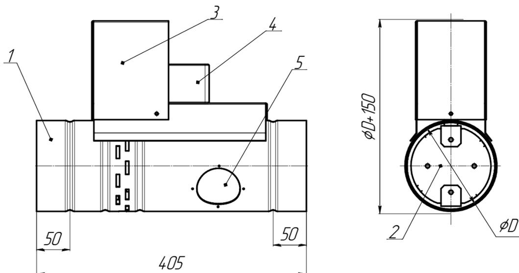
Рис. 2 Круглый клапан с пределом огнестойкости EI 60.
