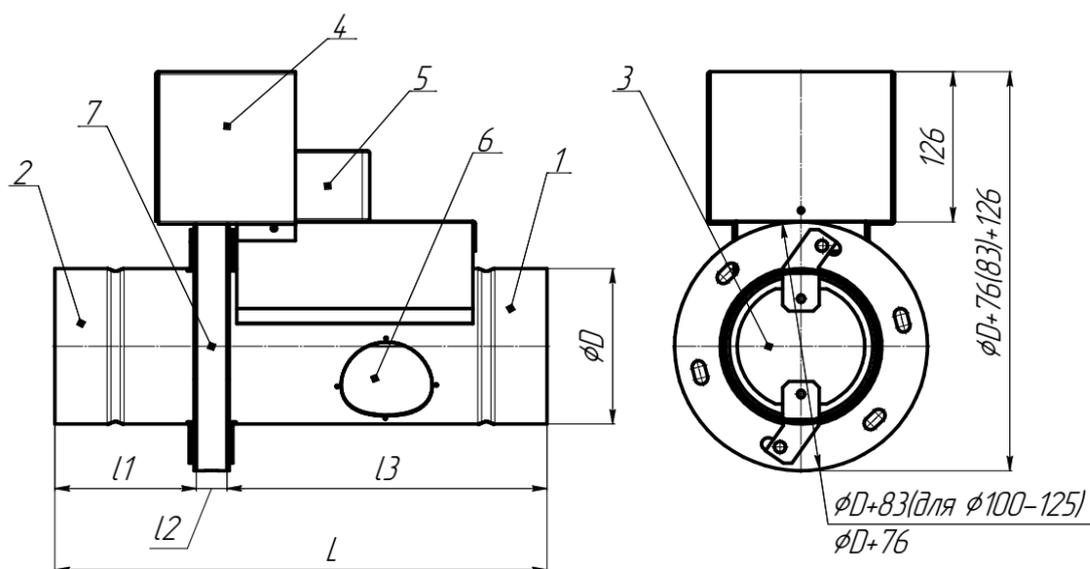
Рис. 4 Круглый клапан с пределом огнестойкости EI 90-180.
