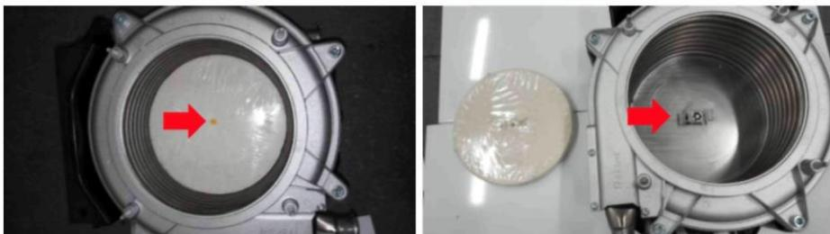
Поверните и снимите деталь, расположенную в центре Duroboard, чтобы установить теплообменник. Поверните и снимите деталь, расположенную в центре Duroboard, чтобы установить теплообменник. Затем поверните Duroboard, чтобы привинтить его к винту, расположенному в центре теплообменника.
