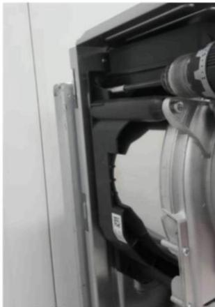
Снимите болты электрода зажигания и ионизации с помощью универсального гаечного ключа.
