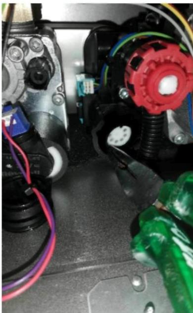
**ПРИМЕЧАНИЕ:** При установке турбины и ограничителя расхода кулачки должны совпадать с каналами. Когда турбина достигнет своего правильного положения, будет слышен звук щелчка.
