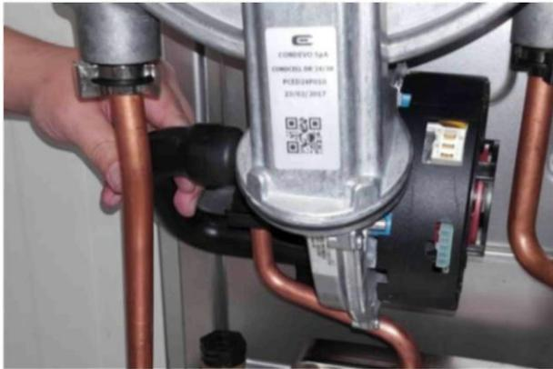
После снятия глушителя снимите трубку Вентури.
