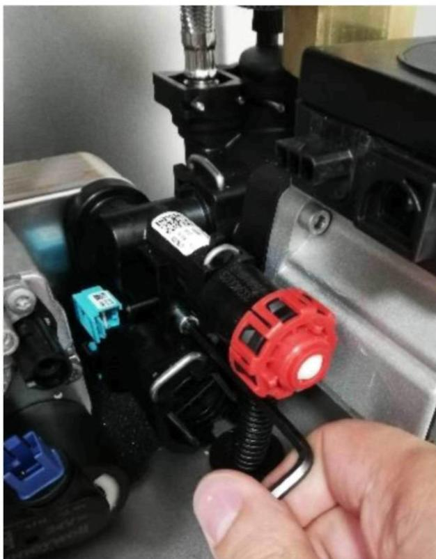
Снимите болт, соединяющий насос и нижнюю часть корпуса.
