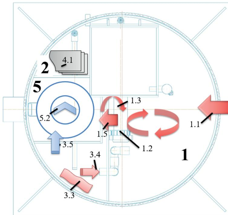
**1 блок:** Зона нитрификации - первичный отстойник. Механическая очистка - удаление взвешенных частиц (мусора, песка и т.д.), сбраживание ила, при котором извлекается легкоокисляемая органика, необходимая для процесса денитрификации. Аэробный процесс осуществляется бактериями, которые окисляют азот аммонийный до нитратов.
