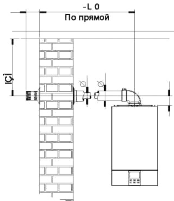
Горизонтальный коаксиальный дымоход
