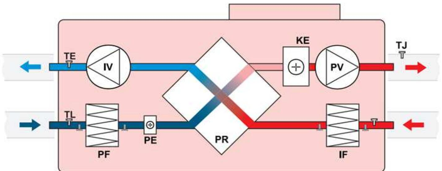
PV – вентилятор приточного воздуха;
