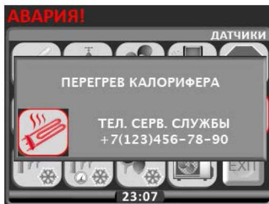
Запуск системы при наличии сигналов аварии невозможен, и каждый раз при нажатии кнопки ПУСК будет выводиться окно АВАРИЯ, до тех пор, пока активные аварии не будут сняты и сброшены.
