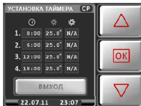
*Дни с активным режимом таймера подсвечены. Для включения / выключения таймеров дня недели – нажать и удерживать в течении 4 сек. соответствующую кнопку. Включение / выключение всех таймеров – нажать кнопку*
