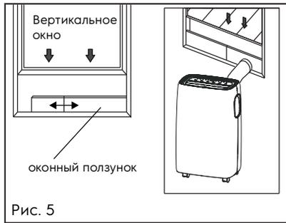
**Примечание:** Если оконный проем меньше минимальной длины комплекта оконных ползунков, обрежьте конец без фиксатора достаточно коротко, чтобы он поместился в оконном проеме. Никогда не вырезайте отверстие в наборе оконных ползунков.
