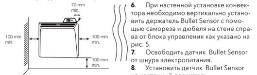
6. При настенной установке конвектора необходимо вертикально установить держатель Bullet Sensor с помощью самореза и дюбеля на стене справа от блока управления как указано на рис. 5.
