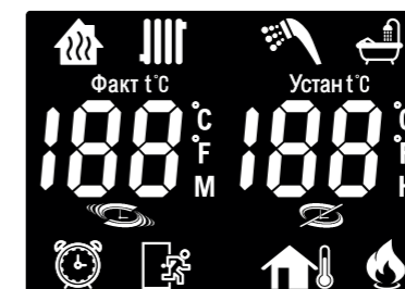
Рисунок 6. Дисплей пульта управления NCTR-60R.
