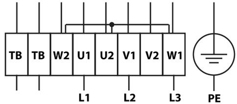
\*- может применяться для частотных преобразователей с входом 230 В, 1ф
