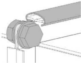
К воздуховодам вентилятор монтируется болтами и С-профилем.
