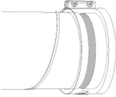
При использовании переходников рекомендуется использовать гибкие соединения круглого воздуховода.
